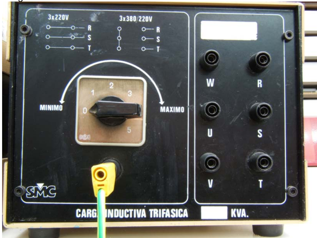
Carga trifásica modificada
