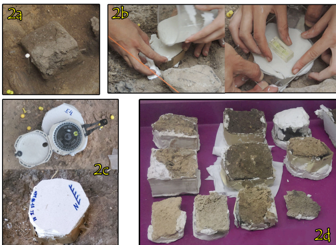
Figura 2. Proceso de muestreo de bloques de mano orientados. [2a y 2b: C. Mallol, B. Galván, C.M. Hernández]
