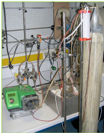
Figura 3. Montaje externo para la medida de la resistencia ex situ .
