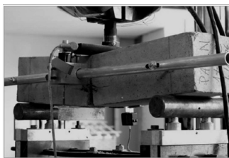
Figura 1. Ensayo de flexión de acuerdo a las recomendaciones de Gopalratnam y Gettu.
